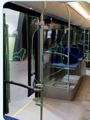
Светодиодная перегородка с выгравированным логотипом для MAN
